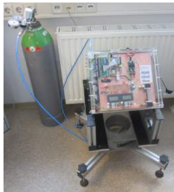
Abbildung 9: Aufgebautes Myonenteleskop mit Gasflasche
