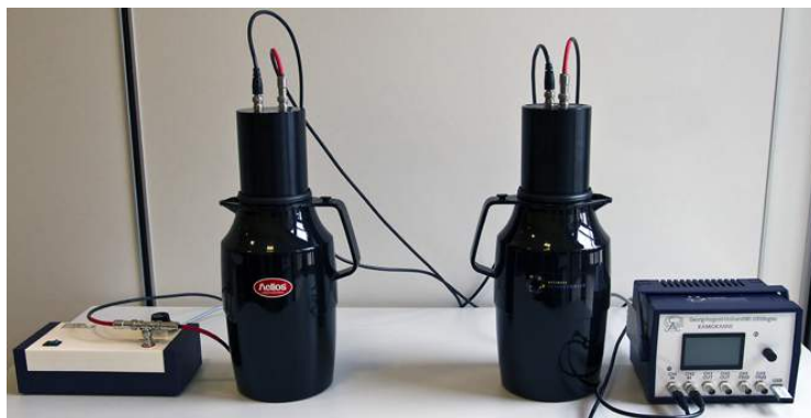
Abbildung 8: Tscherenkow-Detektor für Myonen [15]
