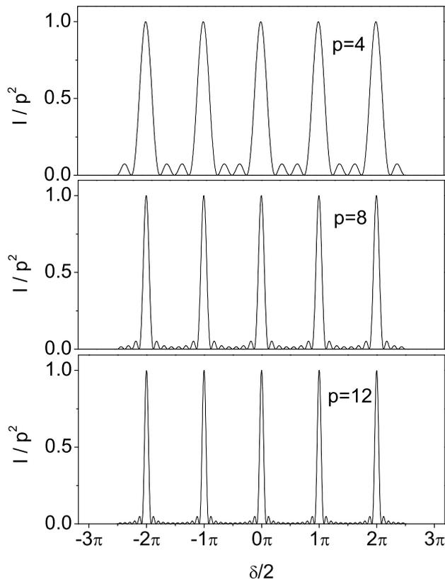
Abb. 4: Intensitätsverteilung eines Gitters gemäß Gleichung (23).
