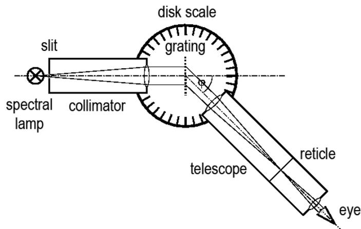
Abb. 1: Spektrometeranordnung zur Vermessung der Spektrallinien von Spektrallampen.
