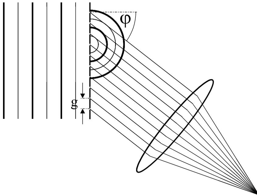
**Abb. 3:** Fraunhofersche Beugung am Gitter.
