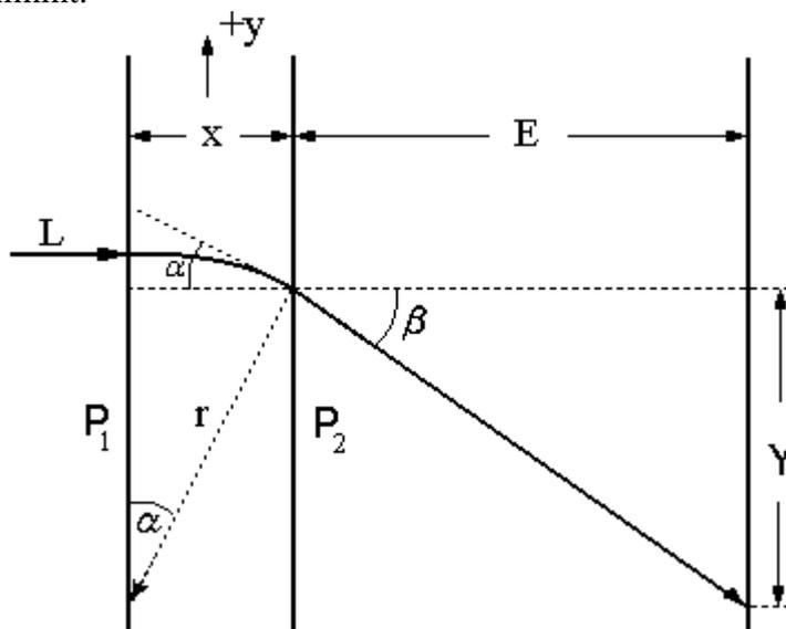
Abb. 3: Schematische Darstellung eines Lichtbündels in einem Medium mit abnehmender Brechzahl in der  $+y$ -Richtung
