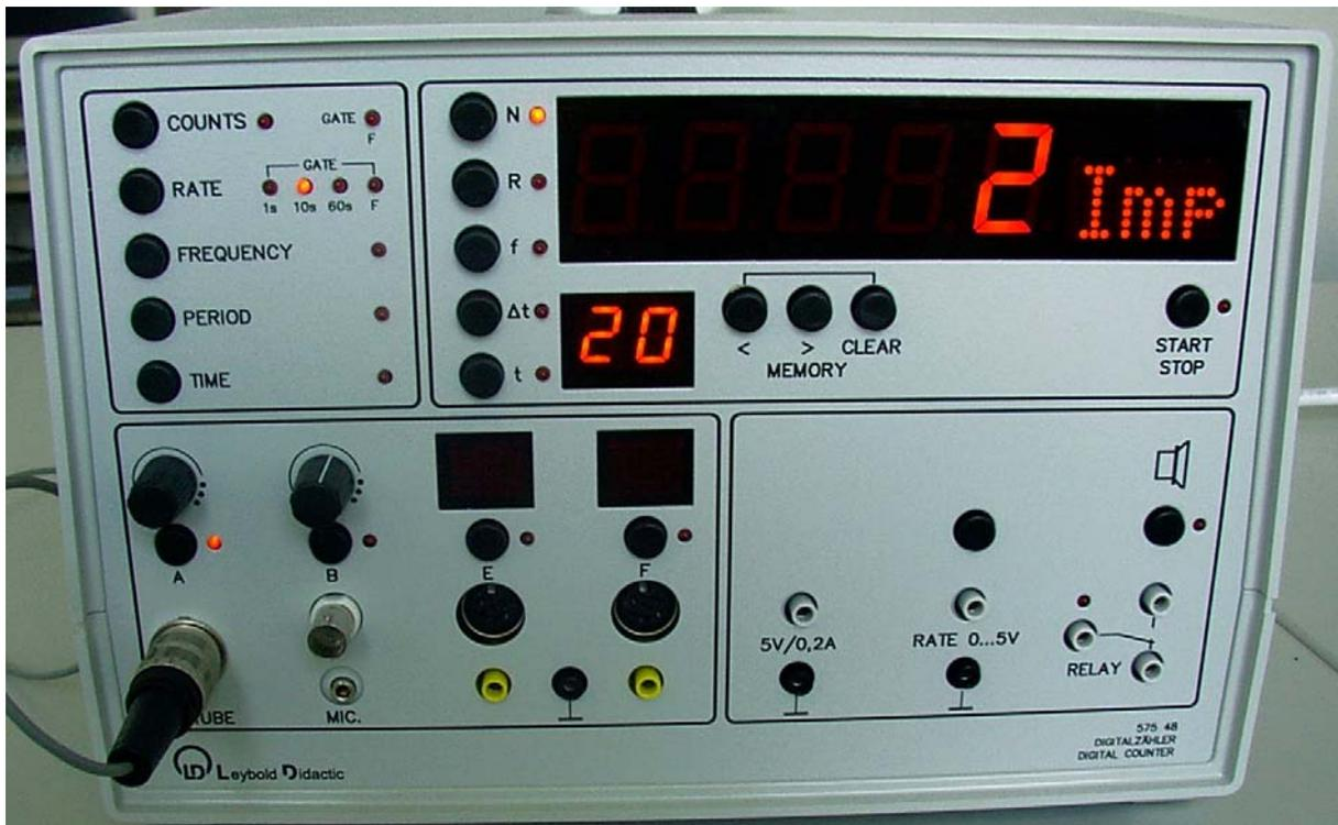
Abbildung 4: Das Zählgerät in der Betriebsart GM TUBE, Impulsratenmessung (RATE) mit der Torzeit (GATE)  $t = 10$  s und Impulsanzeige. Die Spannung  $U_D$  wird mit dem Inkrement-Dekrement-Geber oberhalb des Eingangs A eingestellt.
