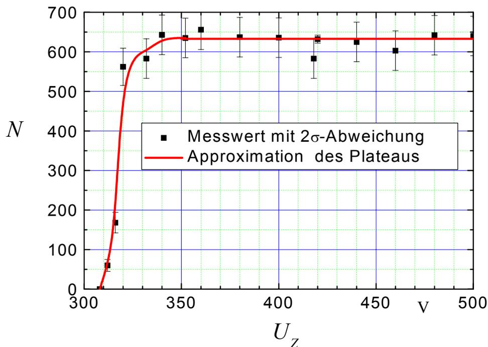
Abbildung 3: Beispiel für eine Zählrohrcharakteristik in der Darstellung  $N = f(U_Z)$
