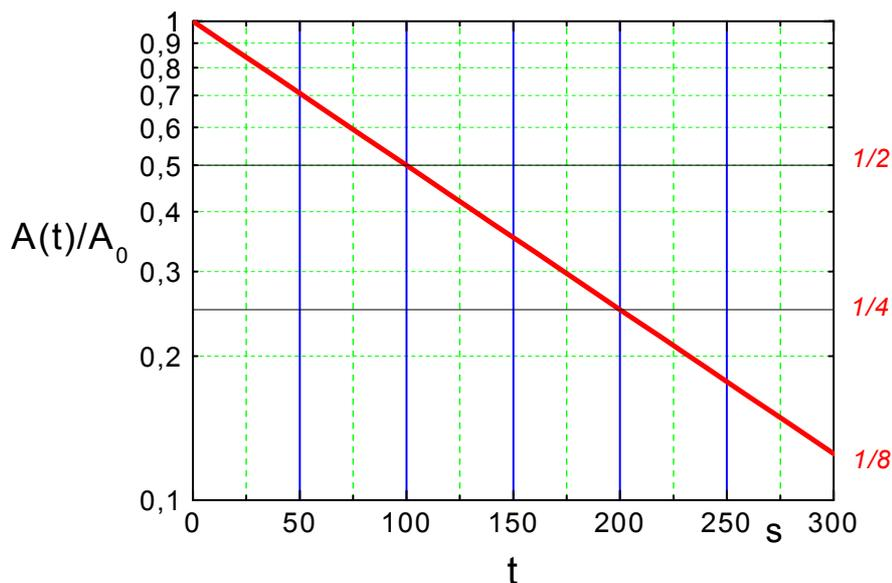
Abbildung 1: Umwandlungskurve eines Nuklids mit  $T_{1/2} = 100$  s in halb-logarithmischer Darstellung
