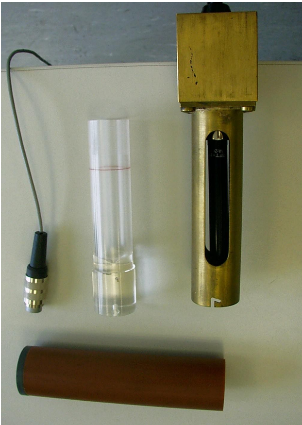
(a) Messkopf für die Aktivitätsbestimmung (von links nach rechts: Anschlusskabel für das Zählgerät, Behälter für die Probenflüssigkeit, Halterung mit Zählrohr und Bajonettfassung; darunter die PVC-Lichtschutzkappe)
