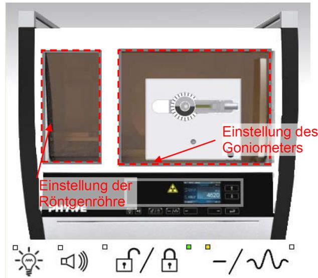
Abb. 10: Röhren- und Goniometereinstellungen mit dem Programm *measure*, Quelle: PHYWE.
