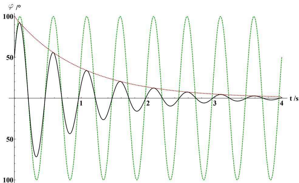
**Abb. 3:** Dargestellt wurden hier eine ungedämpfte Schwingung (grün), eine gedämpfte Schwingung mit  $\delta = \frac{1}{s}$  (schwarz), sowie die Einhüllende (rot).
