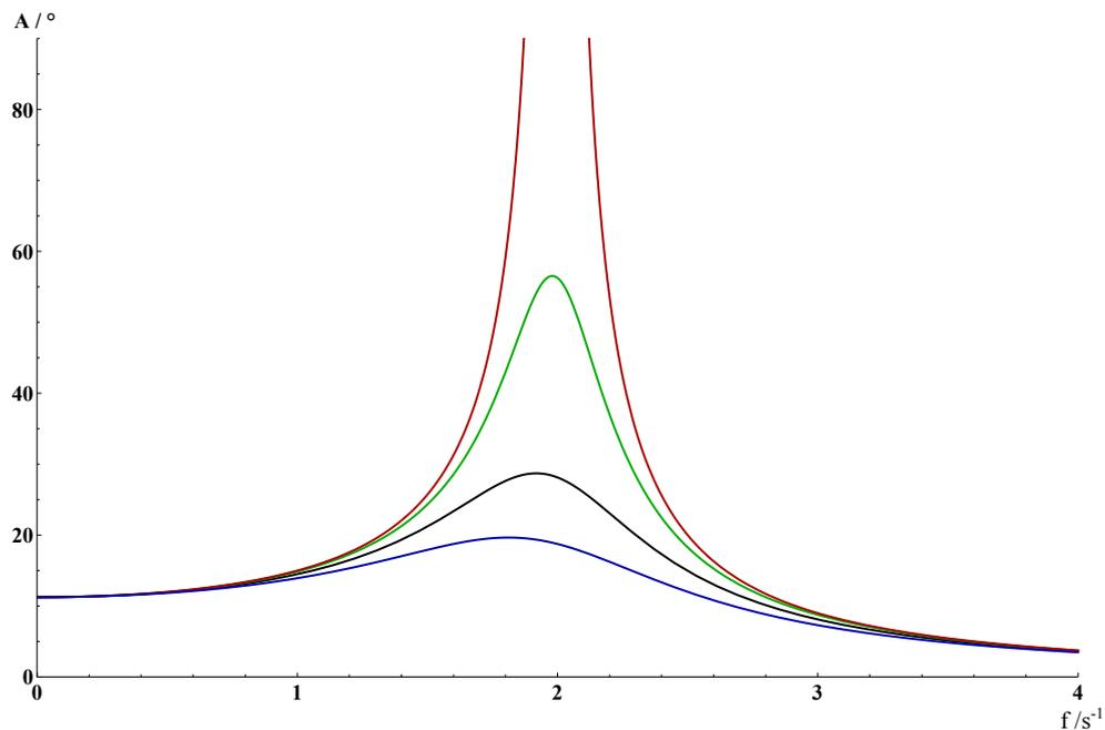
**Abb. 6:** Resonanzkurven für verschiedene Dämpfungen. Die Erregeramplitude wurde zu  $A_E = 45 \frac{\circ}{s^2}$  festgelegt. Man kann leicht die sog. Resonanzkatastrophe erkennen. Es gilt  $\delta_{\text{rot}} = 0 < \delta_{\text{grün}} < \delta_{\text{schwarz}} < \delta_{\text{blau}}$
