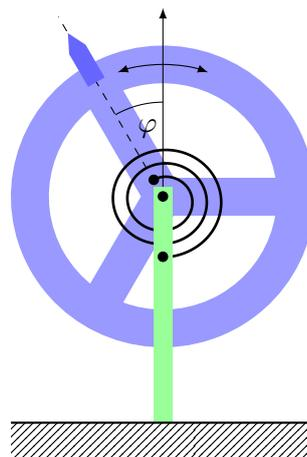
**Abb. 4:** Schematischer Aufbau eines ungedämpften Drehpendels. Das rücktreibende Drehmoment wird durch Auslenkung einer Spiralfelder aufgebaut.
