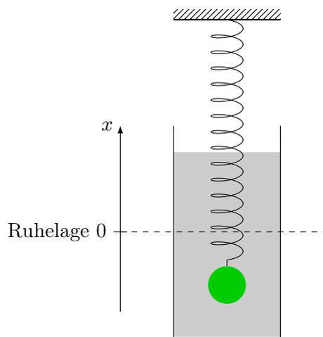
**Abb. 2:** Modell des gedämpften Federschwingers mit der Federkonstanten  $k$  im Ölbad.
