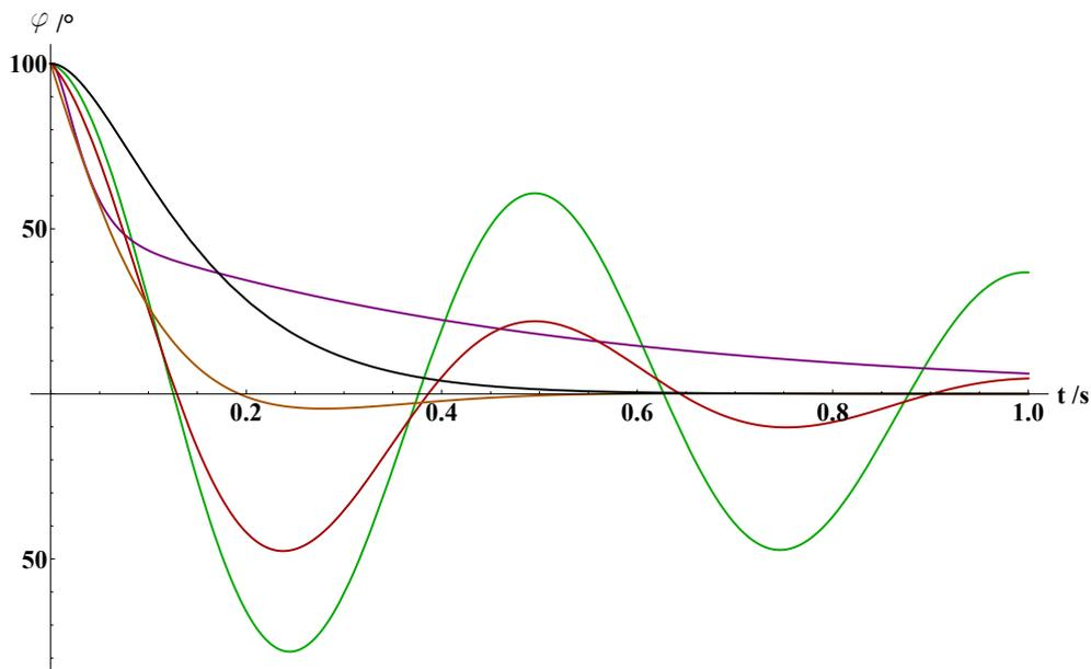
**Abb. 5:** Es wurden gedämpfte Schwingungen für fünf unterschiedliche Dämpfungskonstanten dargestellt. Grün:  $\delta = \frac{1}{s}$ , rot:  $\delta = \frac{3}{s}$ , orange:  $\delta = \frac{9.7}{s}$ , schwarz:  $\delta = \frac{4\pi}{s} = \omega$ , lila:  $\delta = \frac{12\pi}{s}$ .
