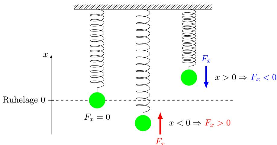
**Abb. 1:** Modell des Federschwingers mit der Federkonstanten  $k$ : Rücktreibende Kraft  $F_x$  in Abhängigkeit von der momentanen Auslenkung  $x(t)$ .
