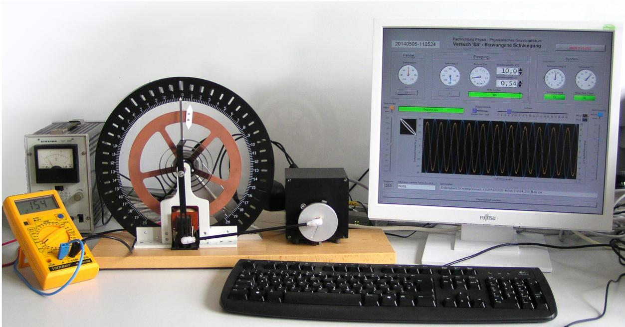
**Abb. 7:** Versuchsaufbau: In der Mitte ist das kupferfarbene Pohlsche Rad erkennbar. Dieses wird mithilfe eines gekoppelten Schrittmotors zu Schwingungen angeregt. Der Zeitverlauf der momentanen Auslenkung wird mittels PC erfasst und kann mit dem der Erregung verglichen werden.
