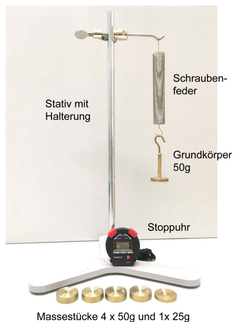
Abb. 1: Versuchsaufbau Federkonstante
