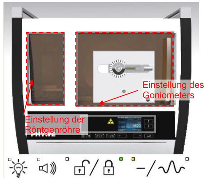
**Abb. 4:** Röhren- und Goniometereinstellungen mit dem Programm *measure*, Quelle: PHYWE.
