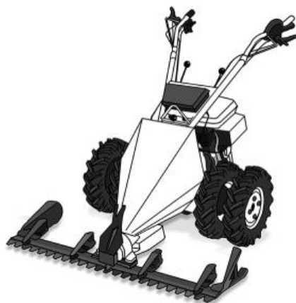
Abbildung 5 Balkenmäher mit schneidenden Element (aus Schmetterlingswiesen)
