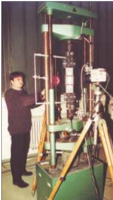
Uwe Hampel bei der photogrammetrischen Rissmessung an einer Probe aus Textilbeton. Foto: ITuB
