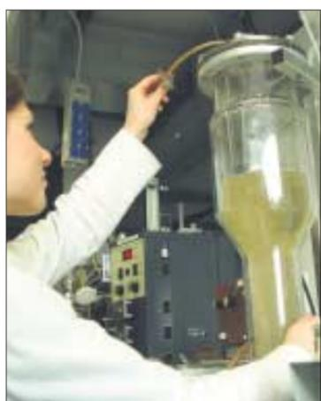
In Bioreaktoren lassen sich Stoffwechselfvorgänge exakt analysieren. Foto: UJ/Eckold
