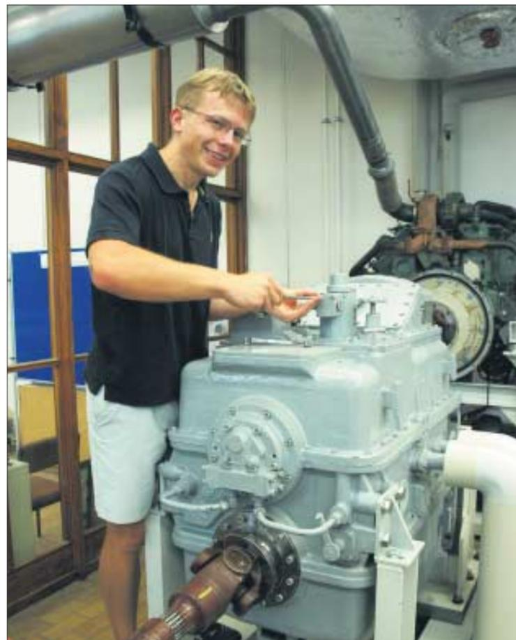
Eric Nietzold am Versuchsstand im Potthoff-Bau. Mit dem Schalter kann er Öl in das Strömungsgetriebe pumpen und es damit betriebsbereit machen. Foto: UJ/Geise
