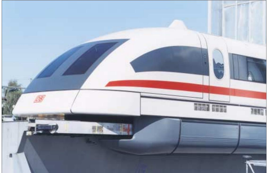
Mit bis zu 500 Stundenkilometern ist der Transrapid schneller als jedes andere Verkehrssystem zu Lande. Die berührungsfreie Technik verursacht keine Roll- und Antriebsgeräusche, so dass der Transrapid im Vergleich zu anderen Verkehrssystemen sehr leise fährt. Entlang der Strecke entstehen keine Schadstoffemissionen und der Flächenbedarf für den Fahrweg ist gering. Foto: ThyssenKrupp
