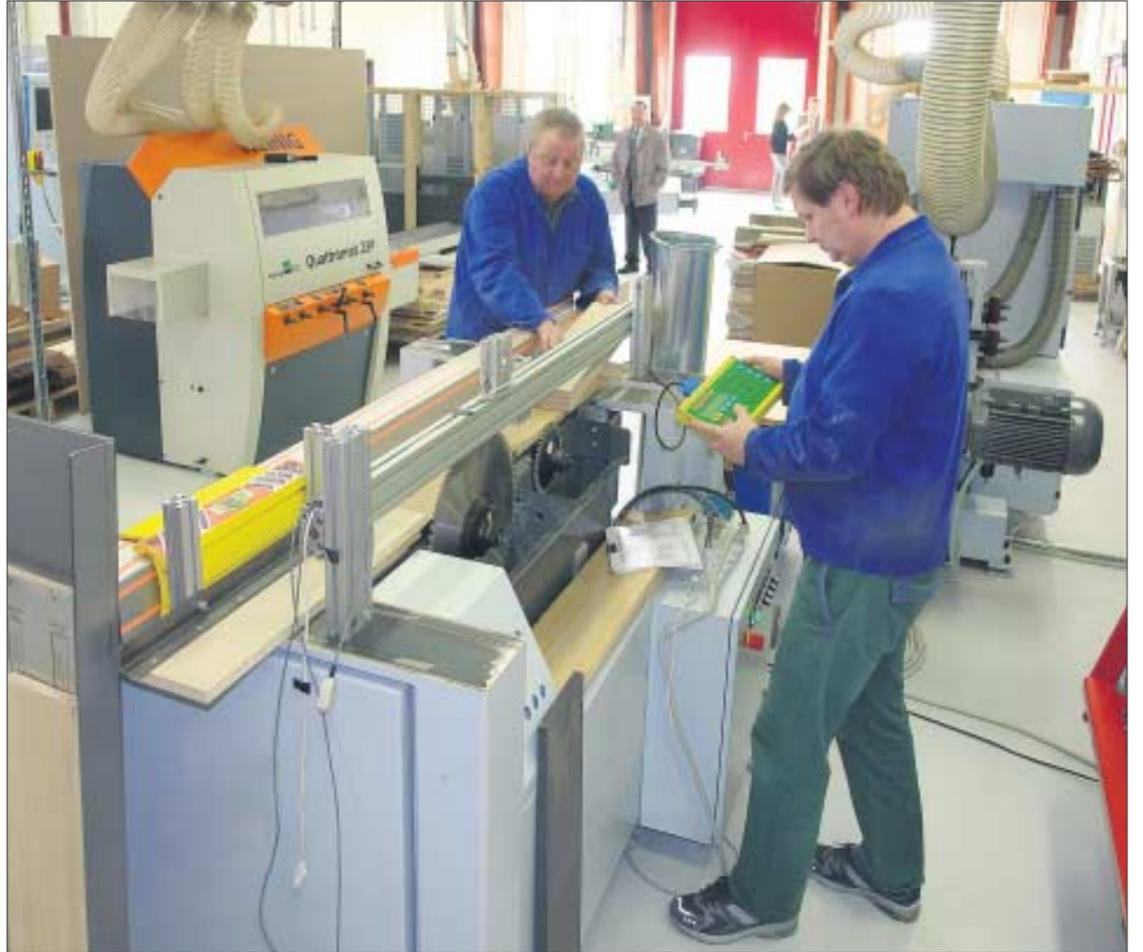
Klaus Ernst (l.) und Thomas Dittler, Technische Mitarbeiter im Holztechnikum, arbeiten am automatischen Sägewagen, an dem erforscht wird, wie sich Späne möglichst energiesparend absaugen lassen. Fotos (2): UJ/Eckold
