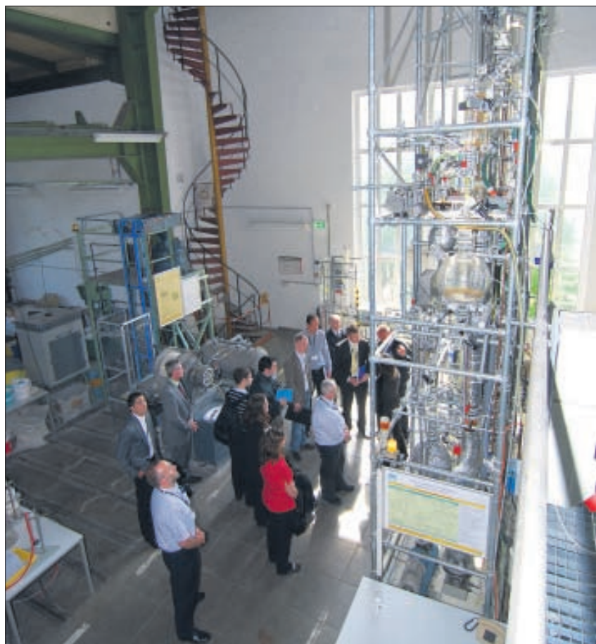
Andrea Ohle, Professur für Thermische Verfahrenstechnik und Umwelttechnik, mit Konferenzteilnehmern an der Versuchsanlage zur chemischen Abtrennung von Kohlendioxid aus Rauchgas. Foto: IET/Heide
