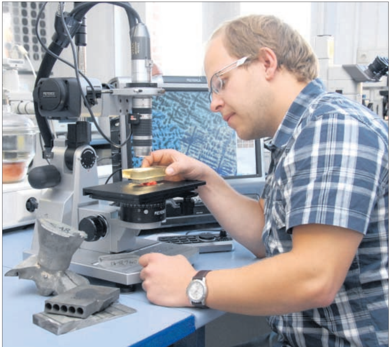
Doktorand Mario Tränkner analysiert am Lichtmikroskop (Metallografielabor im Berndt-Bau) ein Gussgefüge. Foto: UJ/Eckold
