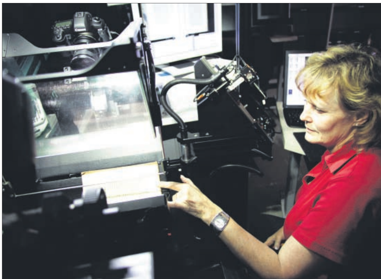
Petra Thiele bei der Arbeit an einem mit zwei Kameras ausgerüsteten Roboter, mit dem stündlich bis zu 460 Buchseiten kopiert werden können. Fotos (2):Petzold
