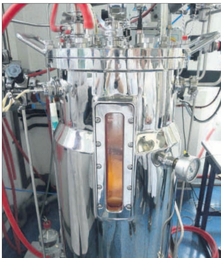
Diesen konventioneller Bioreaktor wollen die Wissenschaftler so modifizieren, dass im Innern wasserstoffproduzierende Mikroorganismen kultiviert werden können. Der Preis des Bioreaktors wird sich dann um etwa 20 Prozent erhöhen.
