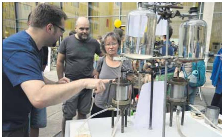
Wie viel Wasser sickert durch? An der Apparatur zur Ermittlung der hydraulischen Durchlässigkeit erklärten Umweltwissenschaftler die Ausbreitung von Wasser in lockeren Sedimenten. Foto: Tominski
